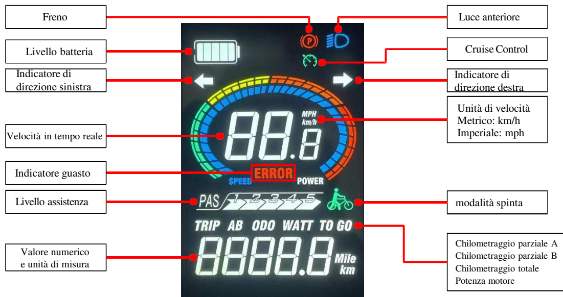
Figura 4-1: Interfaccia di distribuzione delle aree funzionali del DR-200
