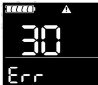
Comunicazione dello strumento anomala
