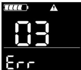
Segnale Hall del motore anomalo
